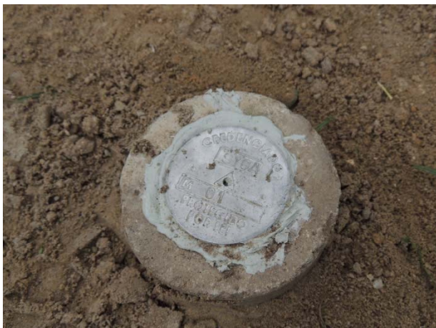
Implantação dos marcos de apoio. (M1)
